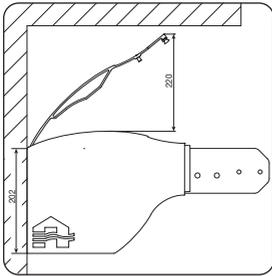
Bei einem Überstand muss eine zusätzliche Höhe von 220 mm zur Verfügung stehen.
