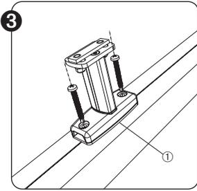
Montieren Sie die mitgelieferten Montagefüße an der richtigen Position. Legen Sie unter jeden Fuß eine Gummizwischenlage ①.
