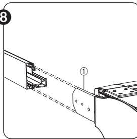
Positionieren Sie die offene Kassette auf den Seitenführungen. Stecken Sie die Ansätze ① der Kassettenkonsolen in die dafür vorgesehenen Aussparungen ② in den Führungen.
