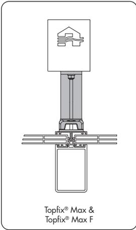
Befestigung der Montagefüße an einem rohrförmigen Träger (darüber liegendes Glas)
