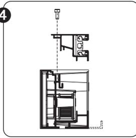
Demontieren Sie die Seitenführung. Dies geschieht durch Herausdrehen der Schrauben DIN912 M4x10 (Inbusschlüssel 3).
