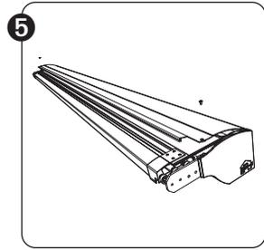
Vor der Montage der Kassette auf dem Dach muss die Abdeckung von der Kassette abgenommen werden. Demontieren Sie hierzu die 2 Flachrundschraben (DIN 966) mithilfe eines Kreuzschlitzschraubendrehers.
