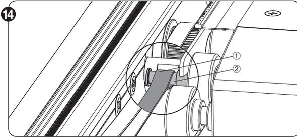
Der Gurt läuft dann von der Umlenkrolle zurück zur Endschiene. Befestigen Sie die Gurtschlaufe ① an der Gurtwelle ②.
