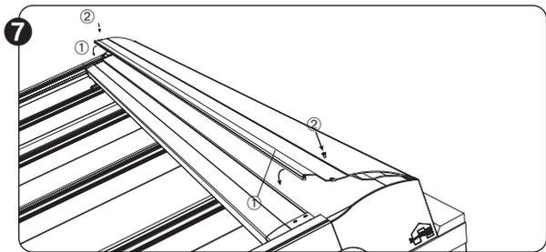
Verschließen Sie die Kassette mithilfe der 2 Flachrundschrauben (DIN 966) mittels eines Kreuzschlitzschraubendrehers.
