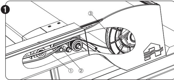
Die Federn in der Tuchwelle sind bereits mit der Spannung des Systems belastet. Das Spannsystem ist jedoch noch blockiert, weil die Endschiene in den Anzugsgabeln sitzt.
